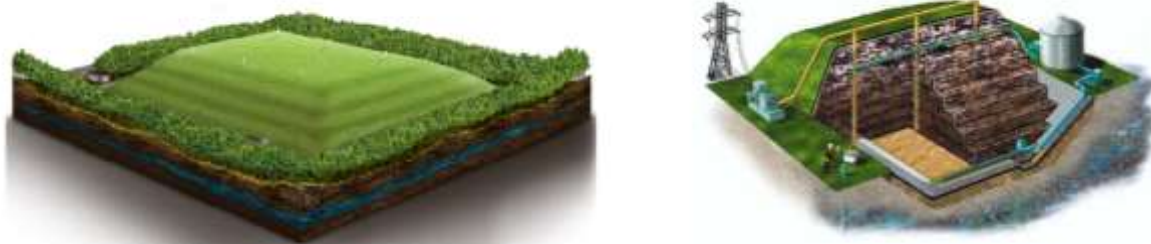
Рисунок 6 – Биологический этап рекультивации полигона ТКО
