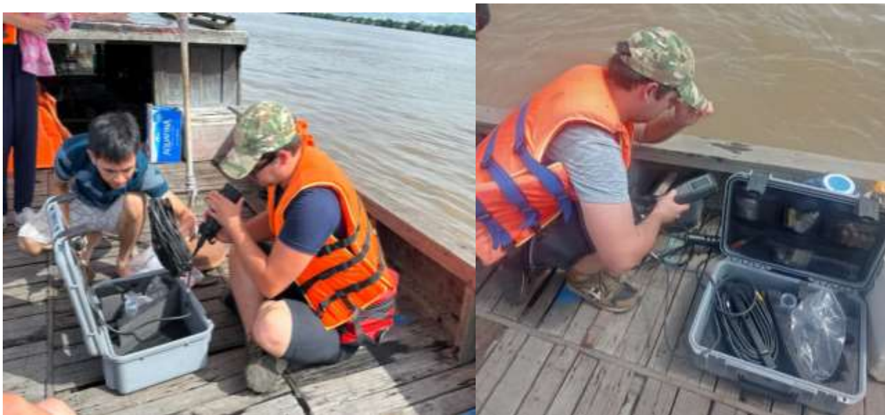
Рисунок 1 – Измерение показателей качества воды анализатором YSI Professional Plus (Pro Plus) Multiparameter Instrument
